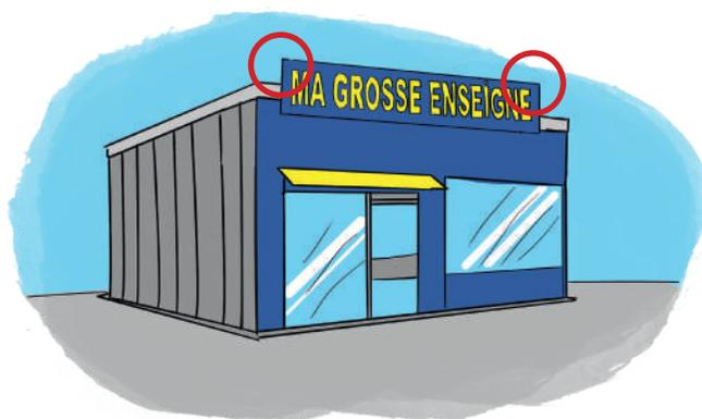
« Les enseignes apposées à plat sur un mur ou parallèlement à un mur ne doivent pas dépasser les limites de ce mur ni constituer par rapport à lui une saillie de plus de 0,25 mètre... »
